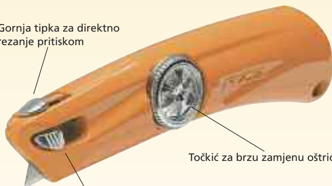
Odrezivanje poklopca - sigurnosni pokrov oštrice pokazuje ugao i dubinu reza.
