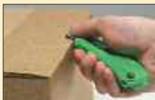
Odrezivanje poklopca - sigurnosni pokrov oštrice pokazuje ugao i dubinu reza.
